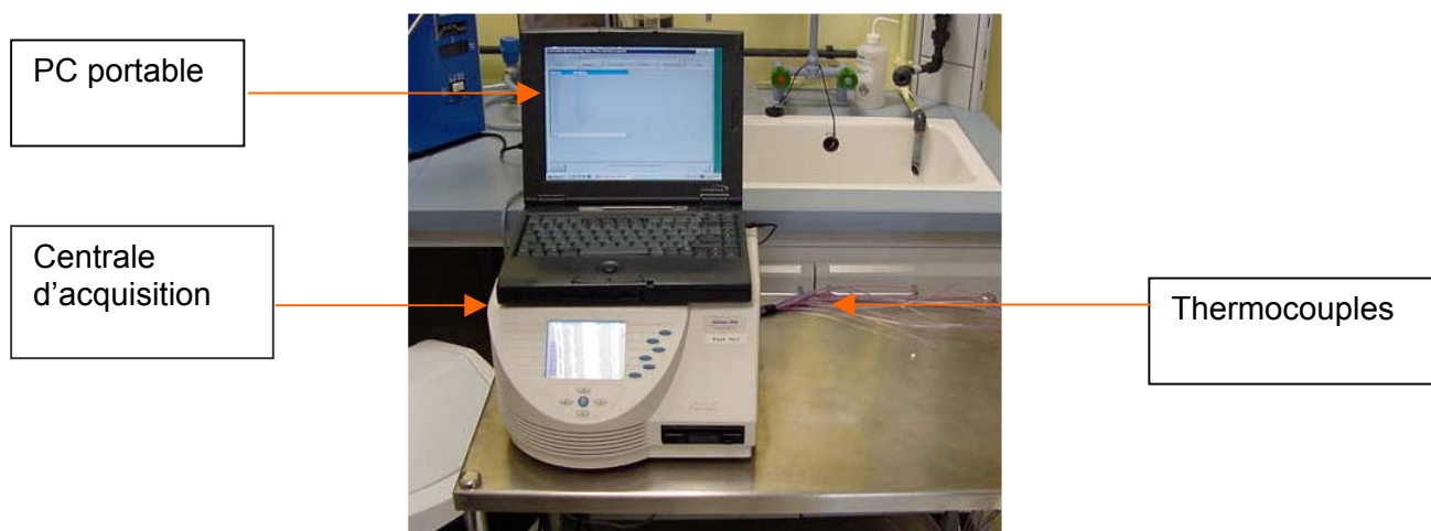
Figure 16 : photographie de la centrale d'acquisition
