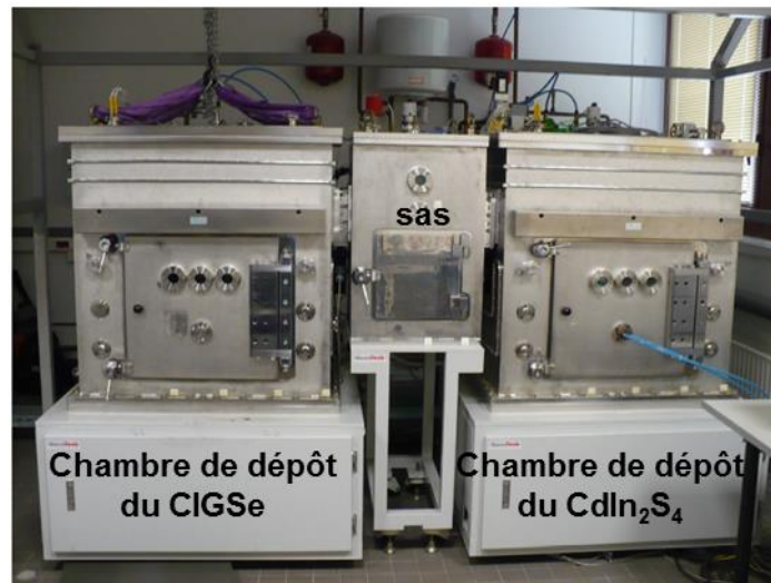
Figure 4-35 : Photo de la machine de dépôt composée d'une chambre de dépôt du CIGSe et d'une chambre de dépôt du CdIn 2 S 4 séparée par un sas sous vide
