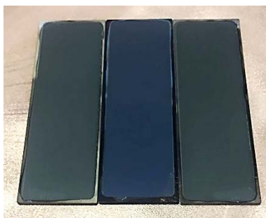
Figure 19 : Photo de couches grises pauvres en cuivre et bleue riche en cuivre (recouverte de sulfures de cuivre)
