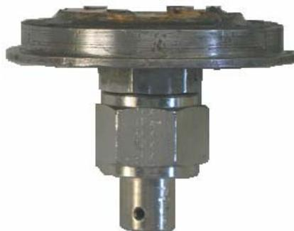
Figure 2 : Cellule électrochimique pour études de diffraction des rayons X in-situ.
