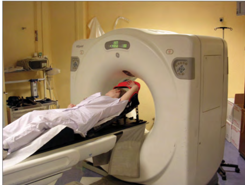
FIGURE 1.7 – Scanner dédié à la radiothérapie avec une table en fibre de carbone et un système pour caler la patiente pour le traitement du sein. (source : www.ch-bourg-en-bresse.fr/ ).
