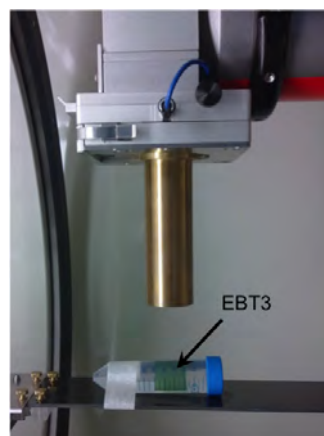
FIGURE 3.8 – Irradiation en archthérapie du tube d'eau contenant le film EBT3.
