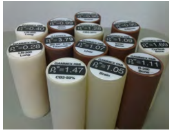
FIGURE 4.7 – Cylindres substitués de tissus issus du fantôme Gammex
