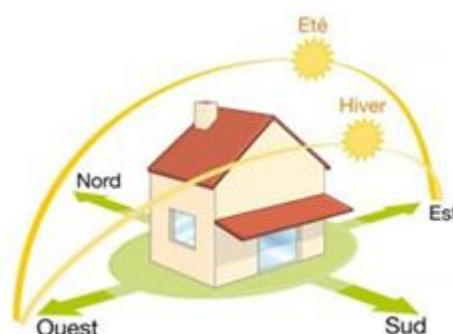
Fig.35 - Orientation d'un bâtiment pour une conception bioclimatique (35)
