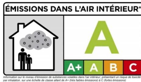
Fig.39 - Étiquetage des émissions en polluants volatils des produits de construction et décoration (55)
