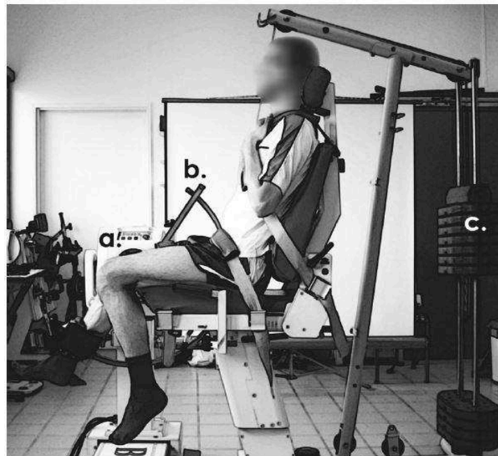
Figure 9. Photographie de l'ergomètre adapté pour réaliser à la fois des contractions isoload et isocinétiques. Un appareil à charges guidées (c.) est relié au moteur d'un ergomètre isocinétique (a.) par l'intermédiaire d'un câble inextensible et une pièce métallique circulaire en acier (b.). Issue de Guilhem et al. (2010c).
