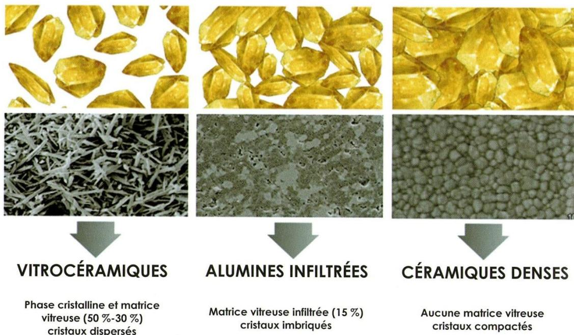
Figure 1 : Les trois grandes familles de céramiques dentaires avec phases cristallines offrent des propriétés optiques de translucidité et de résistance qui sont fonction de leur composition intrinsèque (11)
