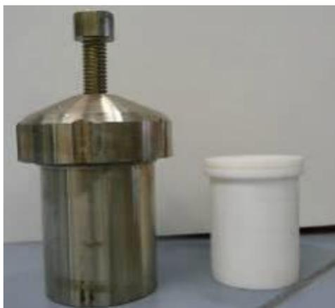
**Figure 12. Photographie d'un autoclave (à gauche) et d'une chemise en Téflon (à droite)**
