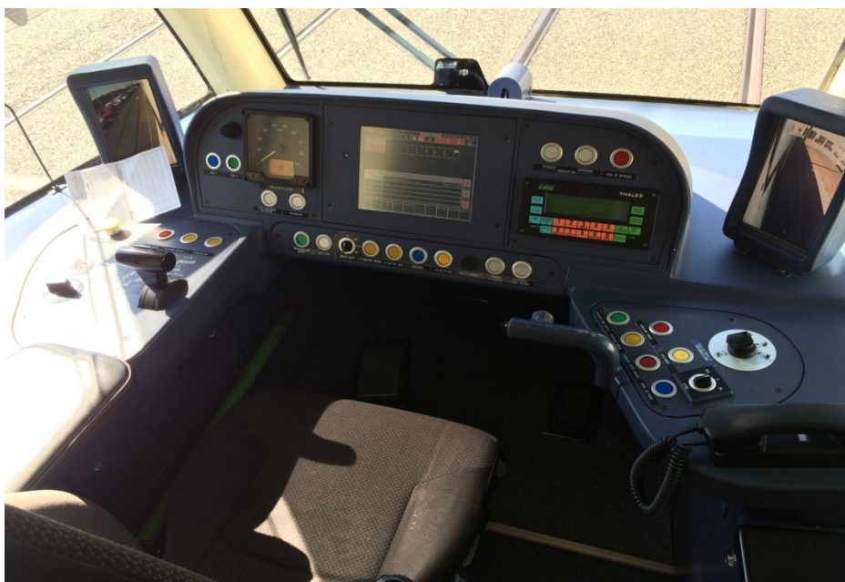
Figure 24 : Loge de conduite CAF.
