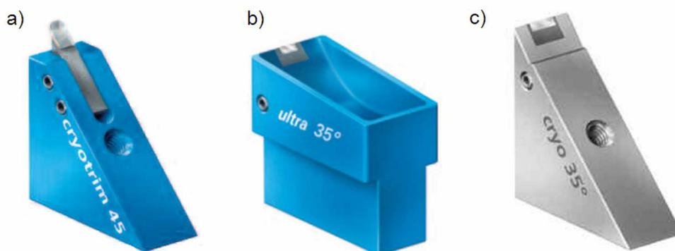
**Figure III.3.** Couteaux diamant utilisés en ultramicrotomie et cryo-ultramicrotomie. a) Couteau en diamant de synthèse à trois tranchants utilisé pour la réalisation de la pyramide. Couteaux diamant b) avec cuvette et c) sans cuvette pour la cryo-ultramicrotomie.
