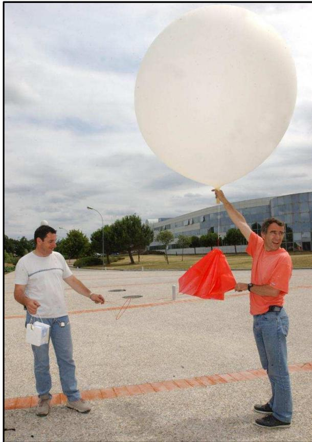
Figure II.3. Exemple de lâcher de ballon-sonde ([www.insu.cnrs.fr](http://www.insu.cnrs.fr)).
