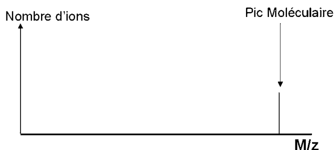
Figure 10 : Spectre de masse en barres obtenu avec une source d'ionisation douce (78)
