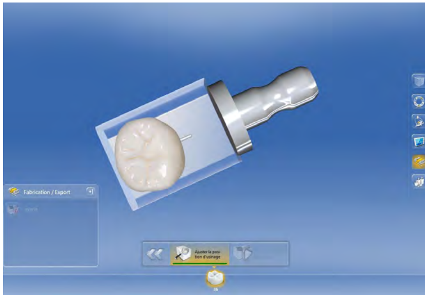
FIGURE 38 : COURONNE PRETE A L'USINAGE
