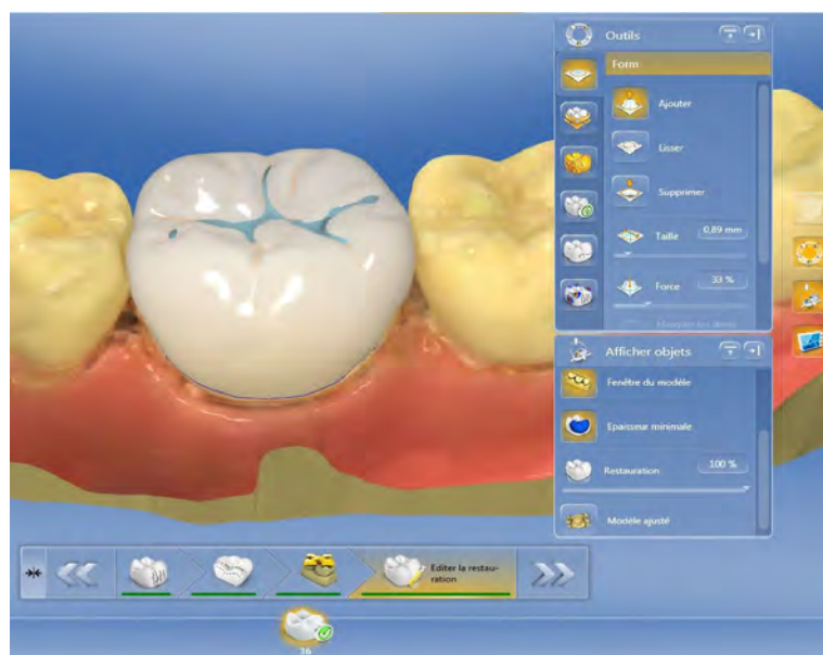
FIGURE 37 : AJOUT DE CERAMIQUE AUX ENDROITS FRAGILISES. FABRICATION VIRTUELLE VALIDE.
