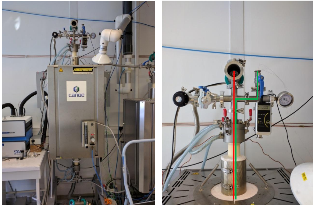
Figure 6-2 : Four de carbonisation (à gauche) et passages des thermocouples (vert) et du toron (rouge) (à droite).
