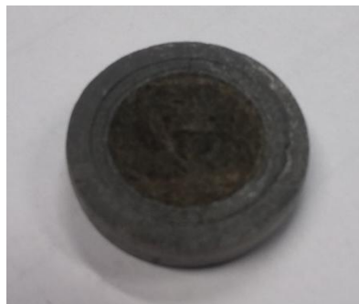
Figure 3-38 : Echantillon pour la mesure de diffusivité thermique longitudinale des fibres de précurseur.
