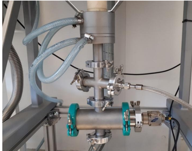
Figure 5-2: Moteur et système d'injection du gaz dans le four statique de carbonisation.
