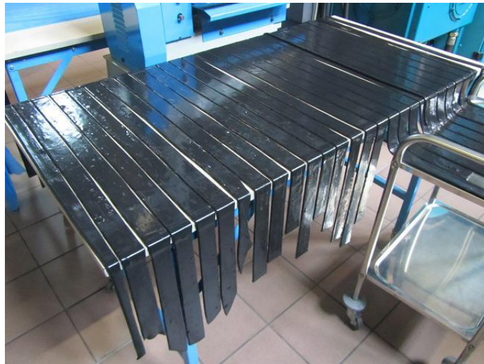
Figure II-62 : Préparation du mélange sous forme de bandes
