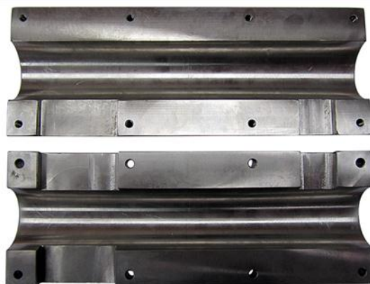
Figure VI-11 : Enveloppe de refroidissement conçue sous la forme de deux demi-coquilles
