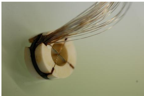
Figure 3 : Photographie d'une cellule de mesure température (CMT)
