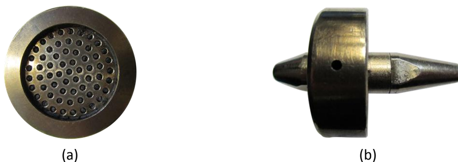
Figure II-60 : Eléments homogénéisateurs placés dans l'extrudeuse : (a) grille, (b) croisillon
