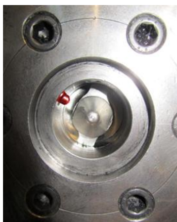
Figure I-34 : Thermocouple monté à la paroi en sortie de vis de l'extrudeuse COLMEC utilisée durant les travaux, (représenté en rouge)
