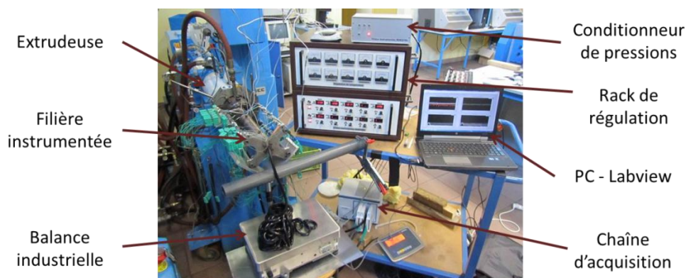
Figure II-36 : Vue d'ensemble du montage
