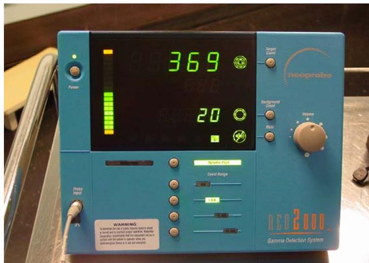
Fig. 4 : écran du compteur, indiquant la radio-activité en coups par minutes (cpm). Ici, le compteur indiquait 369 cpm.
