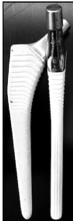
Cette tige existe en versions dites « standard » et « latéralisée » avec 9 tailles pour chaque version. La tige est dite homothétique puisque lorsque la taille de la tige augmente, l'offset et la longueur du col augmentent également et de façon proportionnelle.
