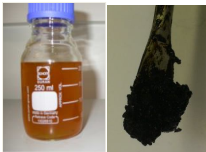
Figure 3-5 : Photographies des différentes fractions obtenues par liquéfaction hydrothermale (phase aqueuse à gauche, mélange entre l'huile et les résidus solides à droite)
