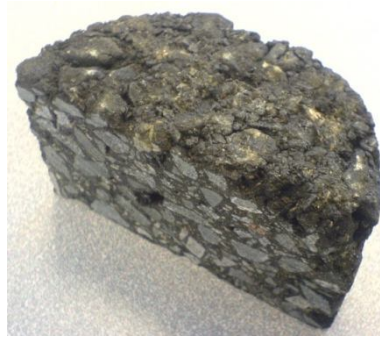
Figure conclusion - 1 : Photographie de l'enrobé réalisé à partir des extraits Soxhlet de Scenedesmus sp.
