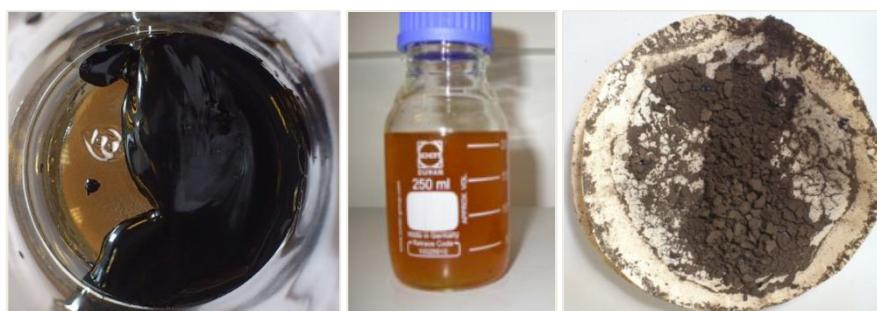
Figure 3-8 : Photographies des différentes fractions obtenues par liquéfaction hydrothermale (bio-huile extraite au \text{CH}_2\text{Cl}_2 , phase aqueuse, résidus solides)
