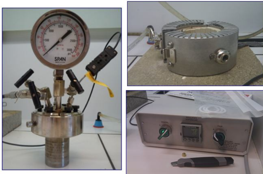
Figure 3-1 : Système de liquéfaction hydrothermale de 50 mL (Parr Instrument Company)
