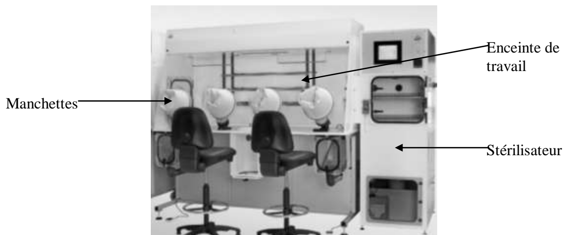
Figure 3 : Isolateur à parois rigides et en surpression (20).
