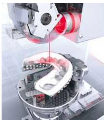
Nouveau scanner 3D du système Nobel Procera, basé sur la technologie d'holographie conoscopique brevetée Optimet
