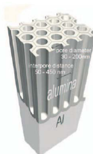
Figure 2-1 schéma d'un réseau nanoporeux d'alumine. [3]
