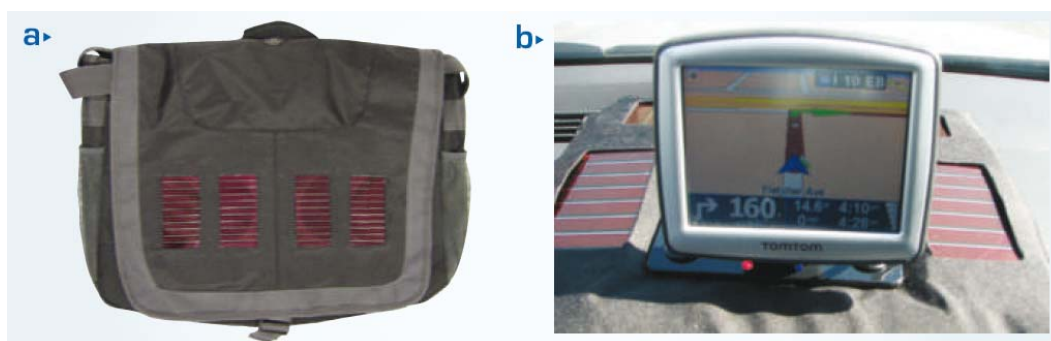
Figure 1-25 Prototypes développés par la société Solarmer Energy. Les cellules solaires polymères flexibles sont intégrées à une sacoche ou combinées avec un GPS [115].
