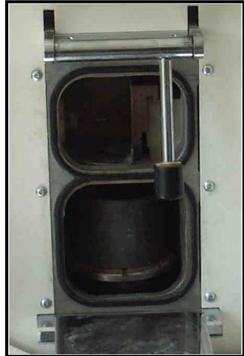
Figure 5 : Chambres de fusion et de coulée, avant puis après basculement d'un quart de tour d'après le laboratoire SANDERS, 2012
