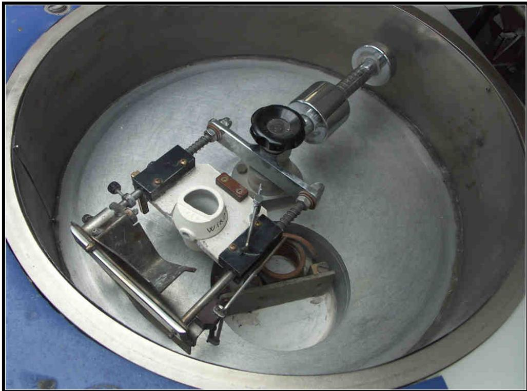
Figure 7 : Machine de coulée par induction/centrifugation
