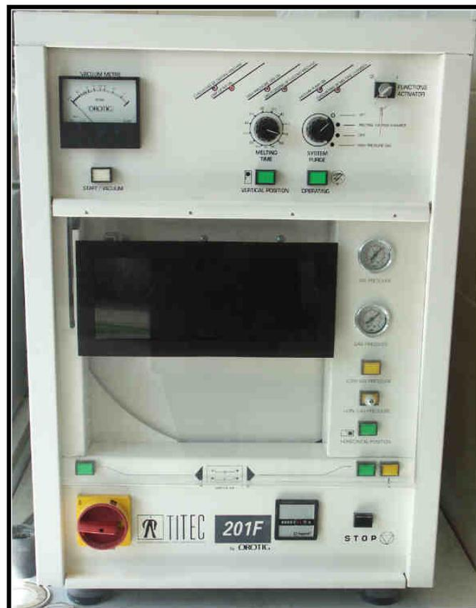
Figure 4 : Machine de coulée du titane par arc/pression-dépression
