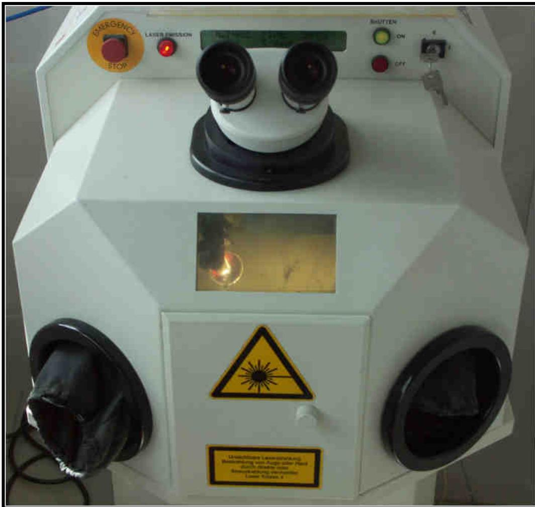
Figure 15 : Soudeuse laser
