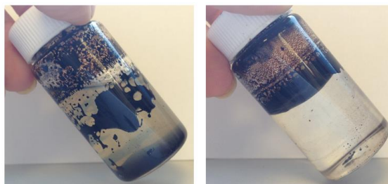
Figure 61. Photographies d'échantillons après déstabilisation totale de l'émulsion E_{2T} . Sans phénomène de contraction homothétique à gauche 3,5.10^{-3} M NaOH et contraction homothétique à droite et 0,5 M NaCl et 3,5.10^{-4} M NaOH à une fraction massique en bitume de 10%.
