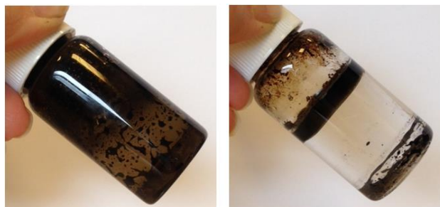
Figure 54. Images de E_{1D} diluée à 10% massique en bitume après la séparation totale de phase à pH 11 sans (gauche) et avec (droite) pré-ajout de NaCl à 0,5 M dans l'échantillon.
