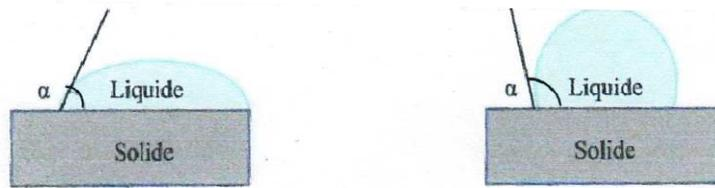
Figure 7. Schéma explicatif de la mouillabilité d'une surface, d'après BURDAIRON G. (1990).
