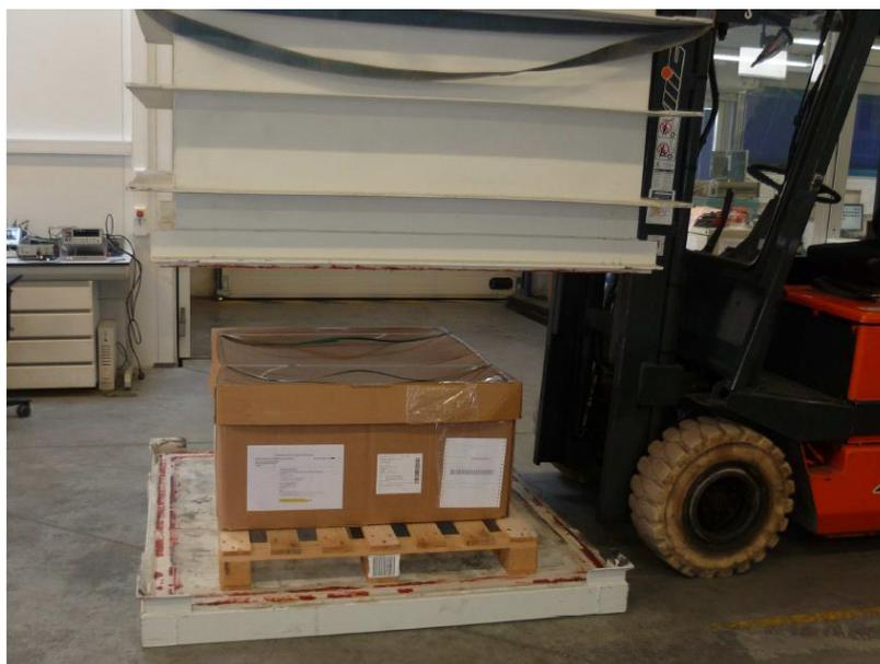
Figure 10: Vue de la caisse en caisson de dépression<sup>(42)</sup>
