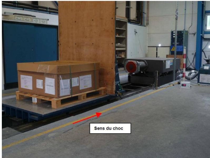
Figure 6: Essai de choc horizontal<sup>(42)</sup>
