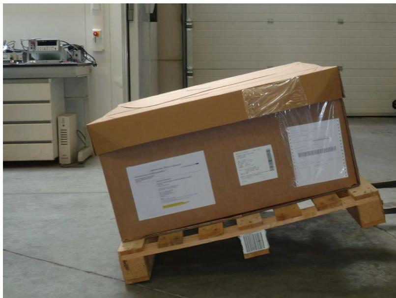
Figure 7: Essai de choc vertical par basculement sur fond<sup>(42)</sup>
