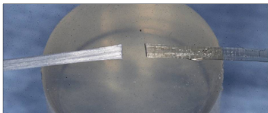
< Fig. 46 – Comparaison entre PermaFiber , fibres de verre non imprégnées (à gauche) et EverStick, fibres de verre préimprégnées (à droite) (Preat corporation).
