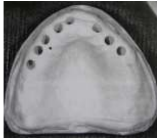
Figure 35 : Modèle en plâtre perforé par le bras robotisé suivant la planification établie par le logiciel CAD Implant® (Fortin et coll 2004).
