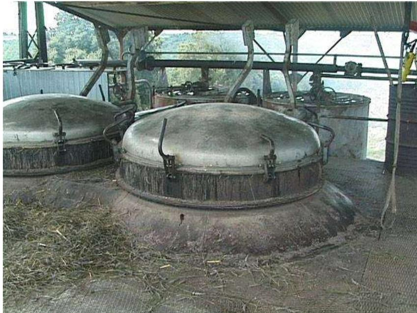
Figure 29 : Cuves de distillation
