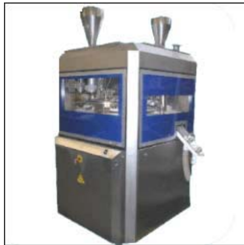
Figure 13 - Presse rotative à double sortie de marque Courtoy ®
