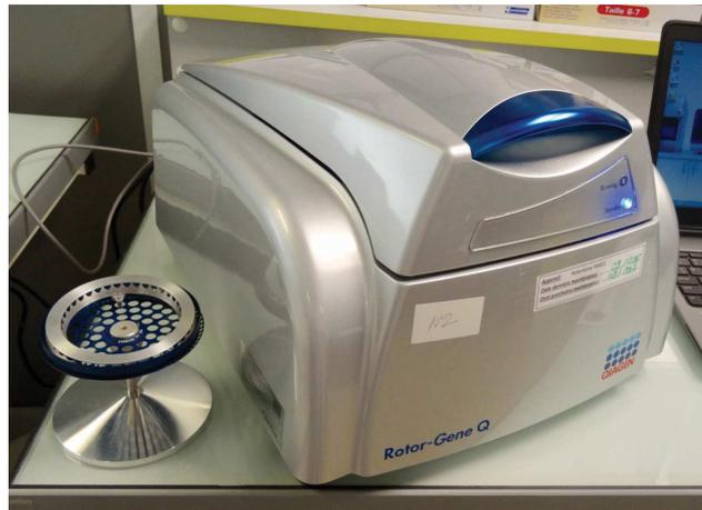
**Figure 16 : Plateforme Rotor-Gene® Q de Qiagen : thermocycleur en PCR temps réel**
