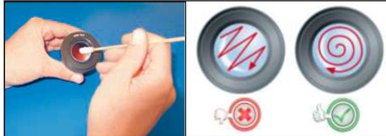
Fig. 21 : Technique de nettoyage des surfaces optiques (72)
