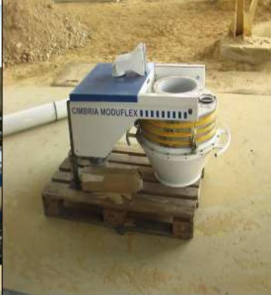
**Photo 12 : manches télescopiques manuelles à descente électrique avec aspiration intégrée permettant le chargement en vase clos.**
