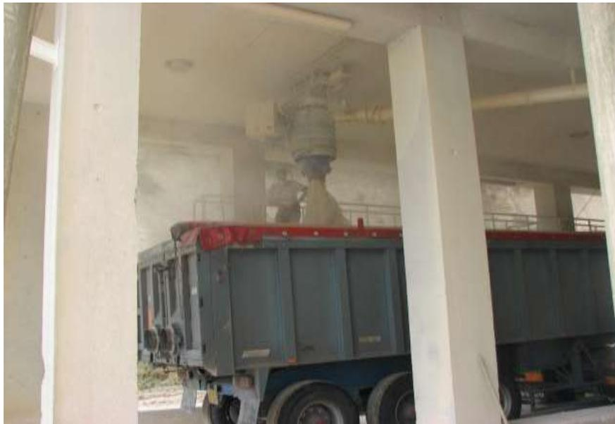
**Photo 10 : chargement du camion benne par le sable sec. L'opérateur se situe sur une passerelle latérale juste au dessus de la benne. L'importance de l'empoussièremment est ici bien visualisée.**
