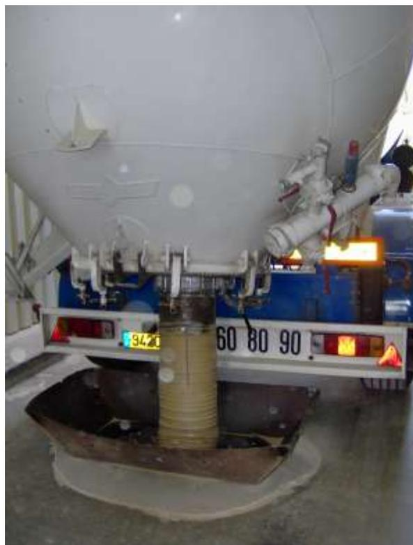
**Photo 15 : déversement du sable par gravité dans une trémie, à l'aide d'un flexible raccordé au goulot de la citerne.**
