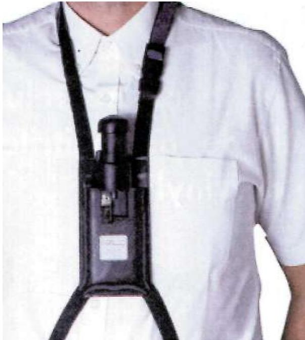
**photo 9: exemple de capteur individuel de poussières pour le prélèvement de la fraction alvéolaire de silice cristalline**
