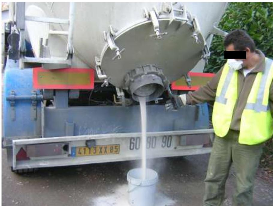
**Photo 18 et photo 19 : action de décolmatage de fond de citerne une fois que le sable est totalement déchargé. Le recueil du sable s'effectue dans un seau et non à même le sol. Le chauffeur porte un masque FFP3 à soupape.**
