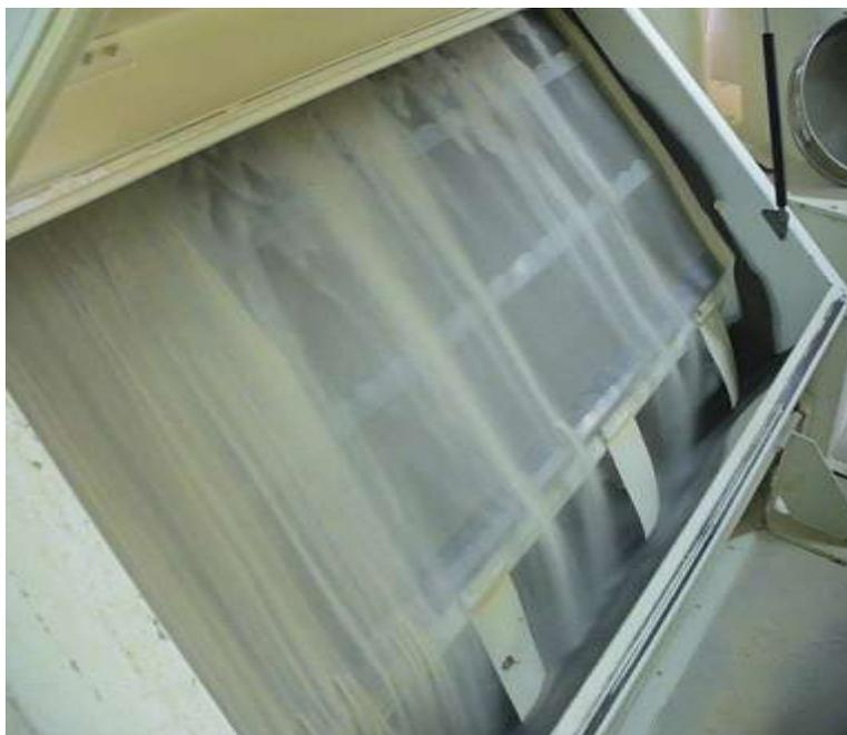
**Photo 8: visualisation du sable blanc concassé et tamisé, qui tombe dans le silos correspondant, après ouverture du capot. Ici c'est le sable de granulométrie la plus fine que nous voyons.**
