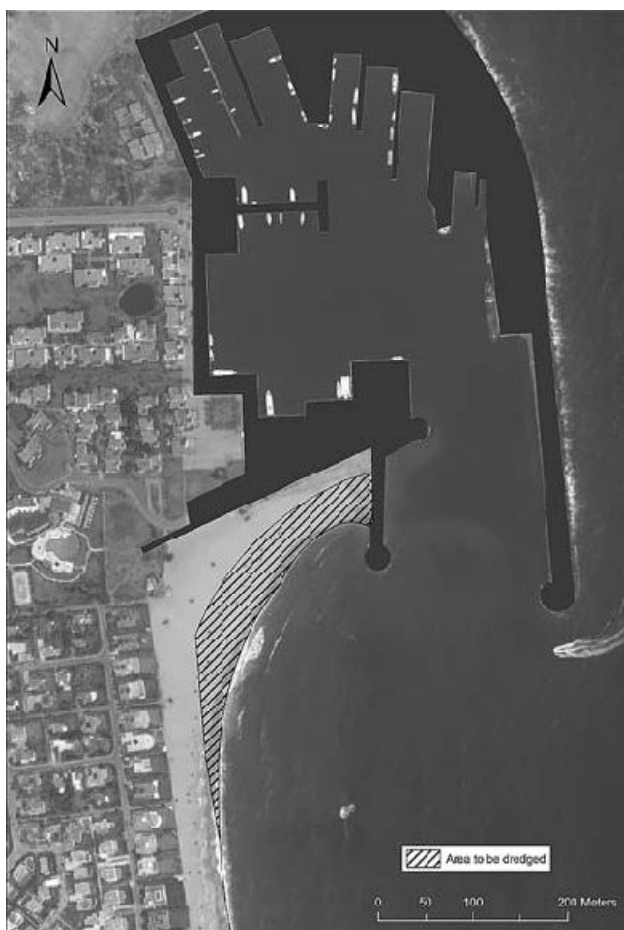
Figure IV. 1 – Action proposée au niveau du port Marina Smir (Anfuso et al., 2007).
