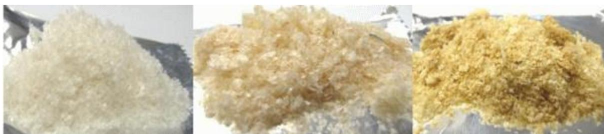
Fig.IV.19 : Chitine obtenue par lavage chimique, par hydrolyse par la pepsine et par l'ASP (de gauche à droite)
