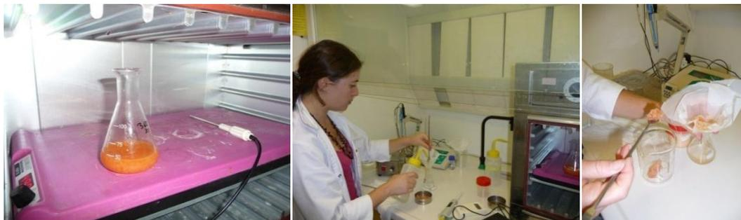
Fig.II.2 : Hydrolyse enzymatique d'exosquelette de crevette par la pepsine en milieu maintenu acide par  $H_3PO_4$
