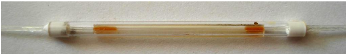
Figure 79 : Photo du coupleur 2×2 à fusion – étirage
