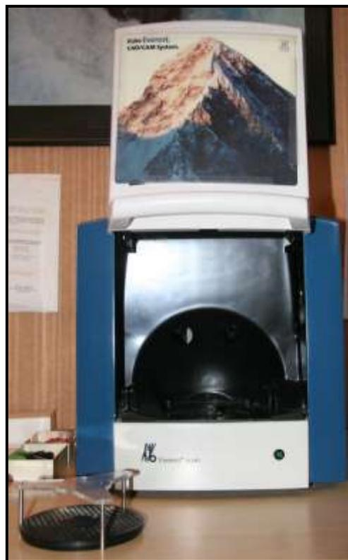
Figure 13 : Photo du positionneur pour le modèle à enregistrer
