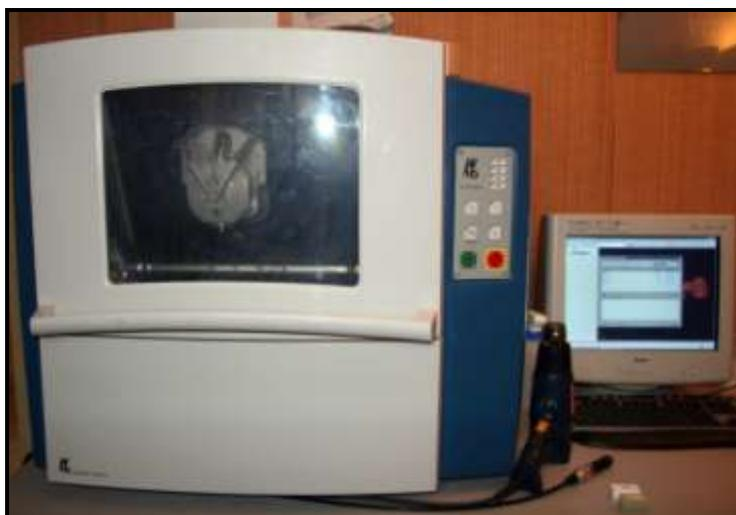
Figure 15 : Photo de l'unité d'usinage cinq axes
