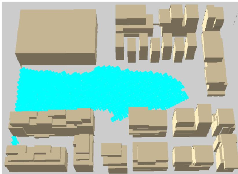
**Figure 10.** *Analyse effectuée sur un SIG – visualisation des points ayant un facteur de visibilité du ciel > 50% (Pham et al., 2007)*
