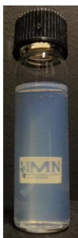
**Figure 59.** Photo de la solution colloïdale de  $\text{TiO}_2$  ( $R = 0/5$ ) notée R0-5\_ $\text{HNO}_3$ . Le logo de l'IMN est vu par transparence à travers la suspension.
