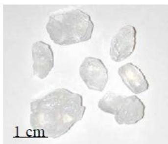
**Figure 17.** Cristaux de  $\text{Ti}_8\text{O}_{12}$  formés par hydrolyse contrôlée du  $\text{TiOCl}_2$ .
