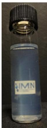
**Figure 68.** Photo de la solution colloïdale de  $TiO_2$  ( $R = OA/OM = 0/5$ ) notée R0-5\_  $HNO_3$ \_EtOH- $I_2$ .
