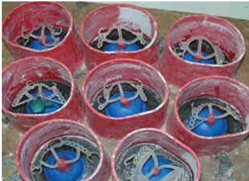
Figure 58 : Modèles sacrificiels positionnés dans les cylindres pour la coulée.
