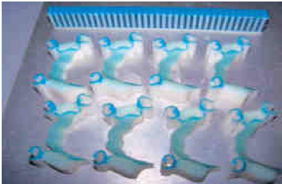
Figure 72 : Impression 3D des maquettes des châssis avec l'imprimante 3D Neo®.
