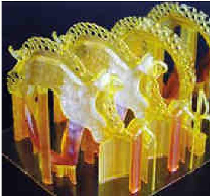
Figure 16 : Production de châssis en résine par le système Perfactory®. [10]
