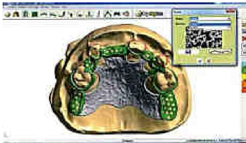
Figure 81 : Tracé du connecteur principal.
