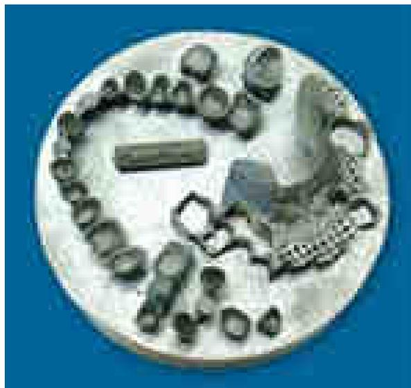
Figure 17 : Couronnes et châssis réalisés pas micro-fusion laser (machine PM100).
