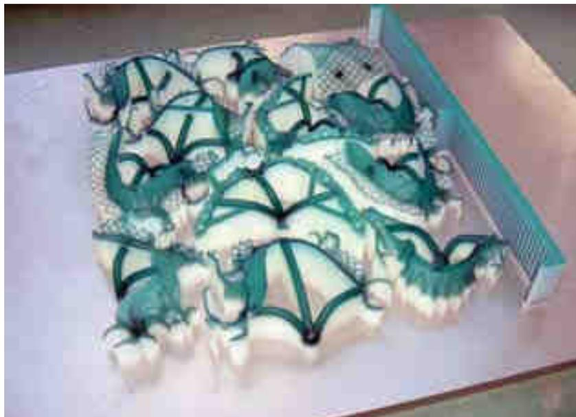
Figure 56 : Préformes en matériau calcinable sur la cire support réalisée par la technique d’impression 3D.
