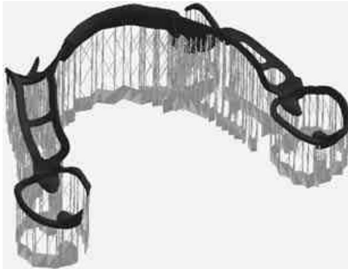
Figure 15 : Prévisualisation d'un châssis avec les tiges de consolidation. [27]
