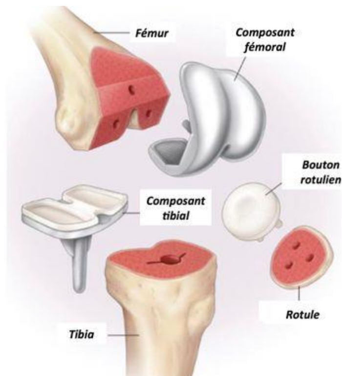
Figure 17 : Schéma illustratif du principe de l'arthroplastie, exemple d'une prothèse de genou (tiré du site internet du centre ostéoarticulaire de Grenoble (130))
