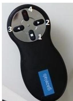
Figure 6. Télécommande et fonctions des boutons
