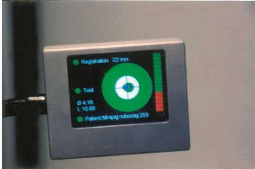
Figure 144: Mini-écran mobile reprenant les informations principales du foret, système Robodent (108)
