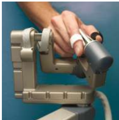
Figure 15: Système de préhension des instruments du Robot Da Vinci® (85, 86) Photo courtesy of Intuitive Surgical, Inc., 2009
