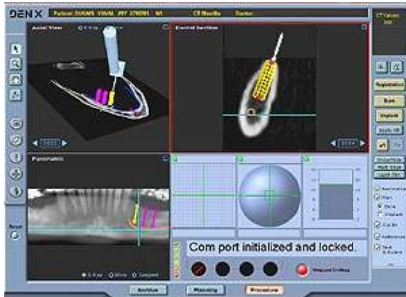
Figure 133: Interface sur laquelle l'orientation du foret est visible dans les 3D en temps réel sur 3 coupes scanner préopératoires différentes (83)
