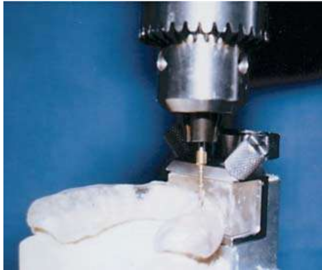
Figure 23: Forage robotisé de la gouttière du système CAD-Implant(59)
