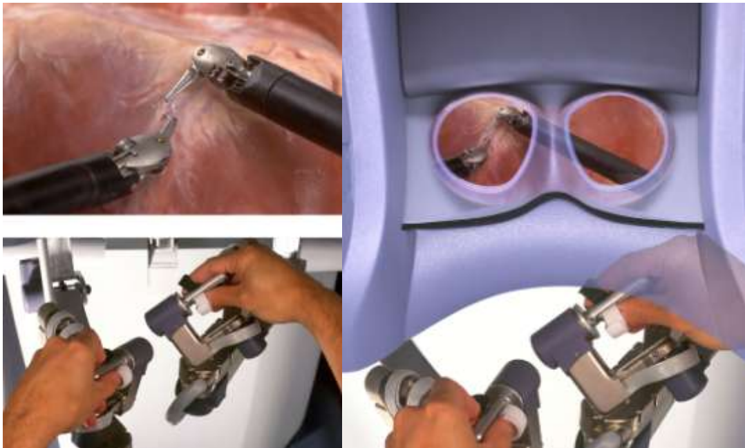
Figure 40: Corrélation entre les gestes du chirurgien et vision sur les instruments effecteurs.
