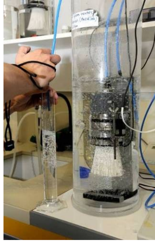
Figure 35 : Mesure du débit de perméation par empotage.
