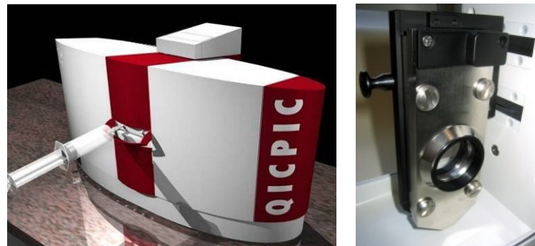
Figure 49 : Granulomètre QICPIC avec système de dispersion LIXELL (Sympatec).
