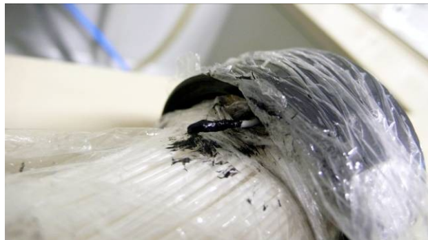
Réparation d'une fibre creuse après échantillonnage
