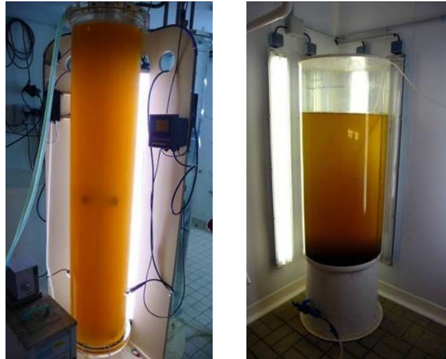
Figure 47: photobioréacteurs d' H. triquetra : A gauche, culture avec régulation du pH (Ifremer Nantes) et à droite, Scobalite de 300 L sans régulation pH (Ifremer Bouin).
