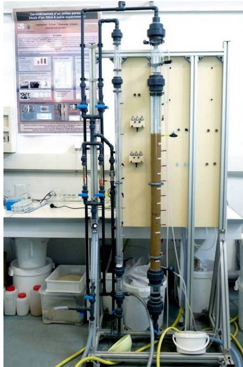
Figure 41 : Pilote expérimental de filtration sur milieu poreux.
