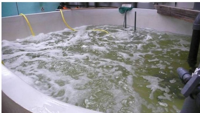
Figure 85 : Bac d'alimentation (7 \text{m}^3 ) : Bloom reconstitué avec 1000 Cellules/mL d' H. triquetra .
