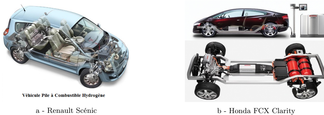
Figure 6.1: – Véhicules à moteur électrique avec pile à combustible hydrogène
