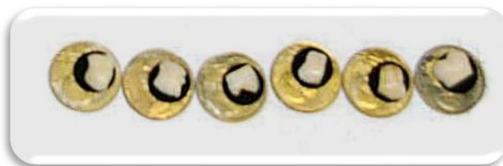
La métallisation a été réalisée par évaporation du carbone dans un vide poussé grâce à un métalliseur Jeol JEE4B.
