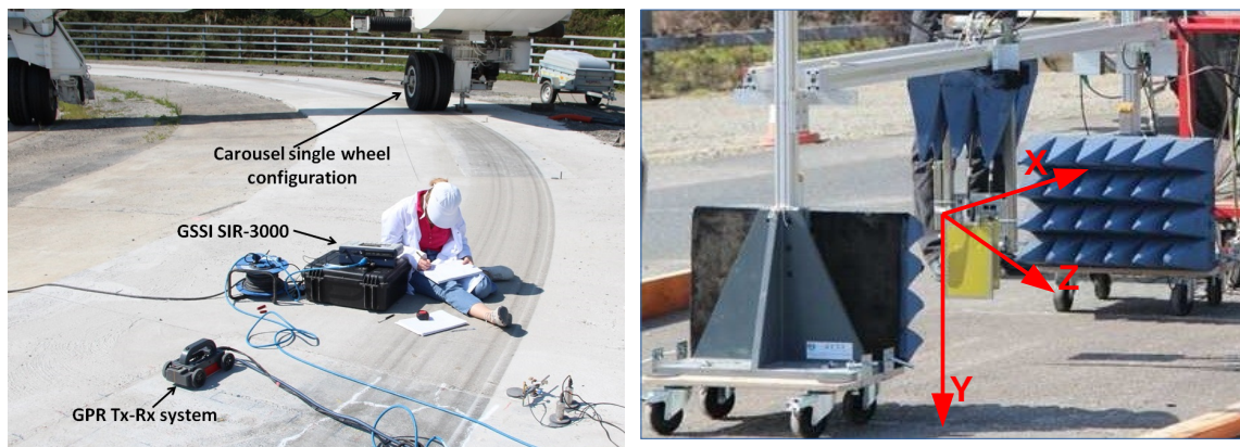
(a) Radar GSSI SIR-3000 (2.6 GHz couplé au sol) (b) Radar ULB à sauts de fréquences (4.5 GHz couplé à l'air)
