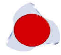
Figure 16 : Section en triple hélice du HeroShaper d'après la société Micro-Méga [42]
