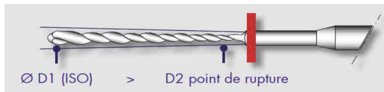
Figure 29 : Illustration de la conicité inversée sur les S-Apex d'après la société FKG [23]
