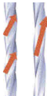
Figure 18 : Illustration de l'effet de l'allongement du pas d'après P. Calas [12]
