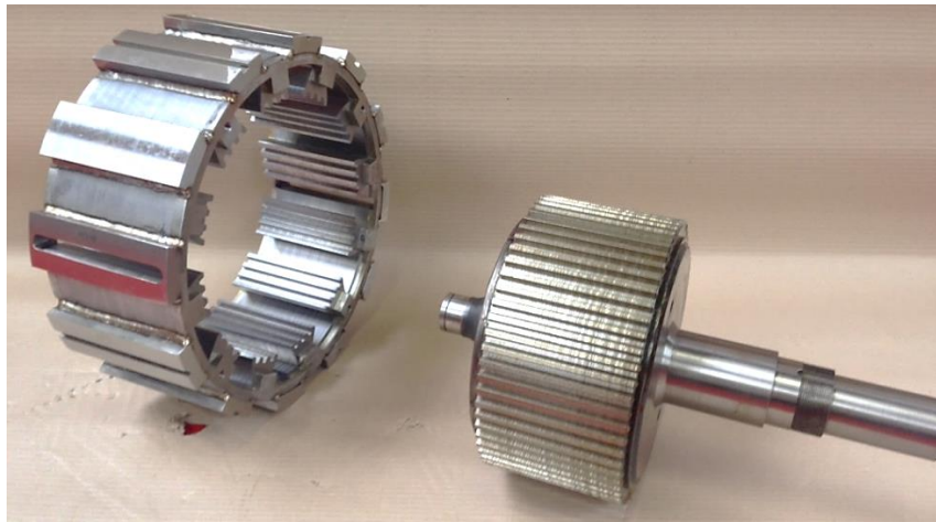
Figure III-4 : Prototype de la DSPM en cours de construction
