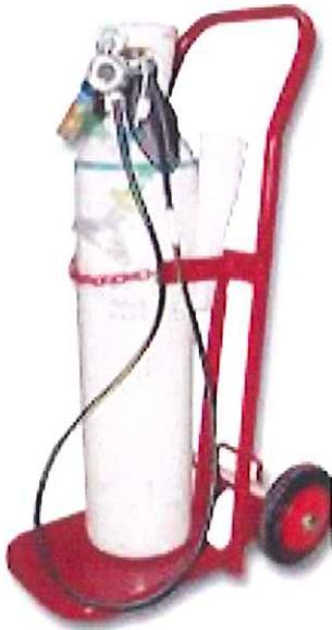
Figure 13 : exemple de bouteille avec porte bouteille.
